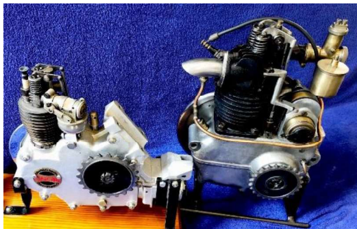
Abb. 5 Eduard Freises 63-ccm Fahrrad-Einbaumotor GNOM und rechts der 250 ccm-Columbus-Motorradmotor (Foto: Hujer)
